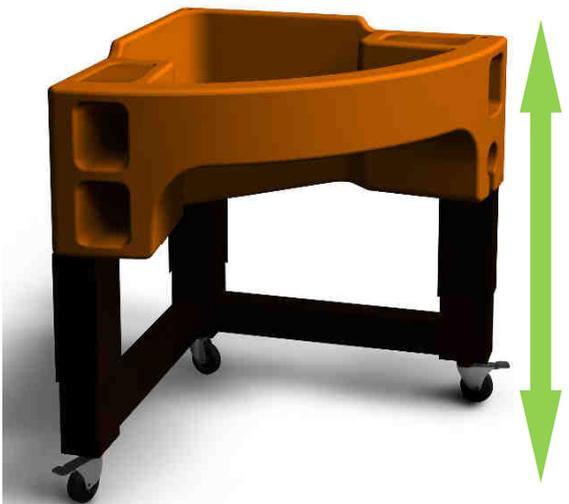
Hauteur réglable de 70 cm à 95 cm dessus plan de travail grâce au système élévateur intégré au pieds métalliques. Manœuvre aisée par manivelle .
